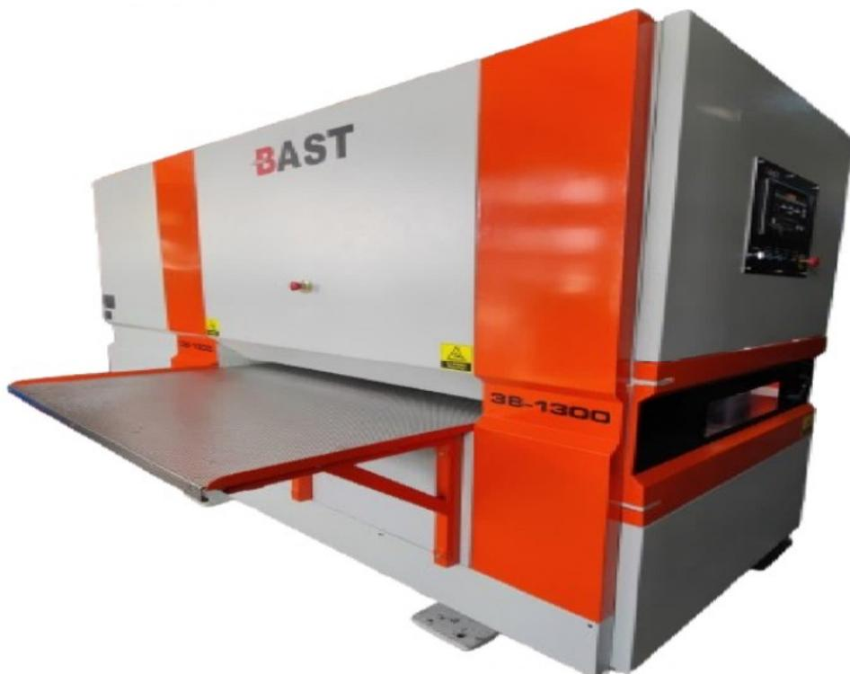
Oggi, tecniche come il taglio laser, il taglio a fiamma e la produzione di lamiere perforate applicate su fogli metallici spesso causano difetti. Tuttavia, la livellatura di precisione a rulli sta rapidamente sostituendo i metodi tradizionali per correggere questi difetti.
